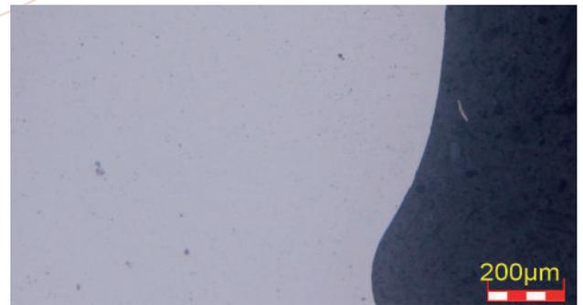
Ces photos illustrent bien la réduction des porosités sur la denture, donc une augmentation de la densité à hauteur de 7.6g/cm<sup>3</sup> et des caractéristiques mécaniques.
